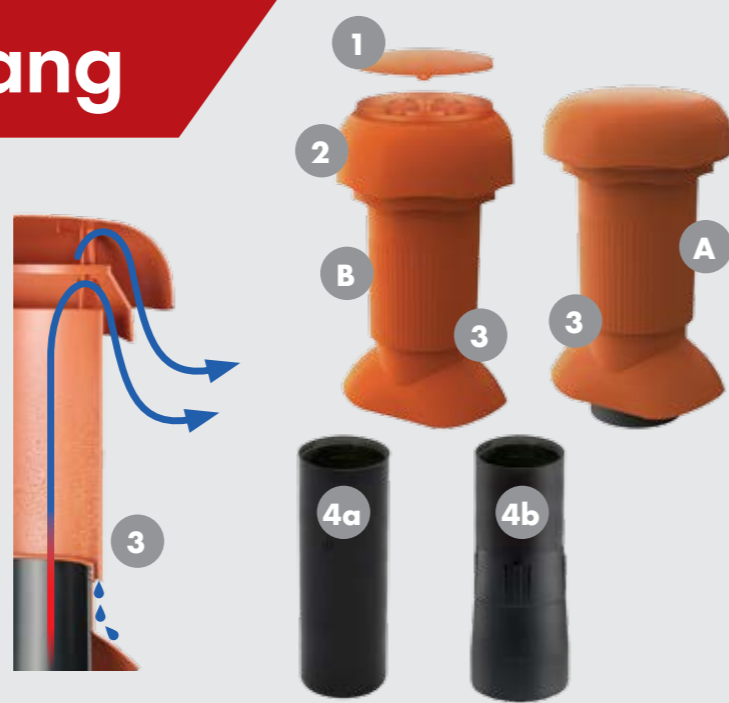
A Be-/Entlüfterrohr DN 125 B Be-/Entlüfterrohr DN 110: 1 Abnehmbarer Schraubdeckel zur Erfüllung der Vorgaben gem. DIN 1986-100 2 Wetterkappe 3 Oberrohr mit Kondensatabführung 4 (a) Unterrohr zum Anschluss an DN 110 (b) Konisches Unterrohr zum Anschluss an DN 125
