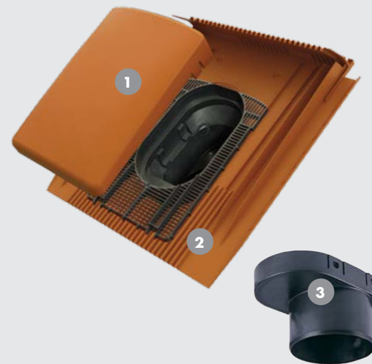
1 Flache Lüfterkappe passend unter Aufdachsolaranlagen 2 Universelle Grundplatte in Standardausführung für flach bis mittel profilierte Dachziegel und Dachsteine, Decklänge 310 - 350 mm 3 Adapter DN 110 und DN 125 für verschiedene Nennweiten
